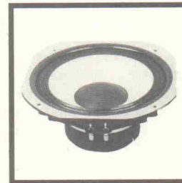
WS 32 AW: HiFi-Tieftöner, Gußkorb, weiße Show-Membran, 120/180 W, 80-1500 Hz, 317 x 317 mm
