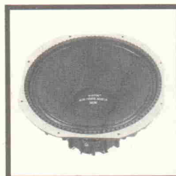
BGS 40: Professioneller Musik-Lautsprecher, Alu-Gußkorb, Kühlrippen an Magnetkappe, Alu-Schwingspulenträger 260/380 W, 30-5000 Hz, 399 x 399 mm.
